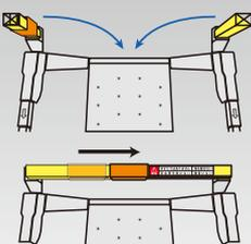
内側に倒し、連結させるだけの簡単設置。昇降面からの墜落の危険を防止!
